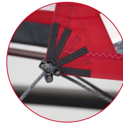
Genuaschotbefestigung am Schothorn Einhängen ohne Verknoten.
