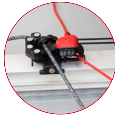
Genua-Schot mit Barberhauer ist wie das Großschot mittig am Boot angeschlagen. Dadurch übersichtlich und leicht bedienbar.
