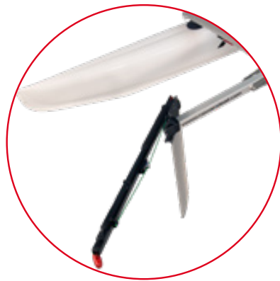
Automatisches Gegenruder Wenn bei der Wende das Boot (mit back gestelltem Genua) anfängt zurück zu laufen, klappt das Ruder zurück und erzeugt automatisch das - bei Katamaran Seglern bekannte - Gegenruder legen. Und das immer im richtigen Moment. Nämlich dann wenn das Boot tatsächlich anfängt zurück zu laufen. Ein Riesenvorteil für Einhandsegler.
