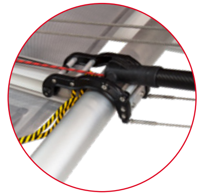
Bugspriet mit hochfestem Carbonrohr für härteste Bedingungen.
