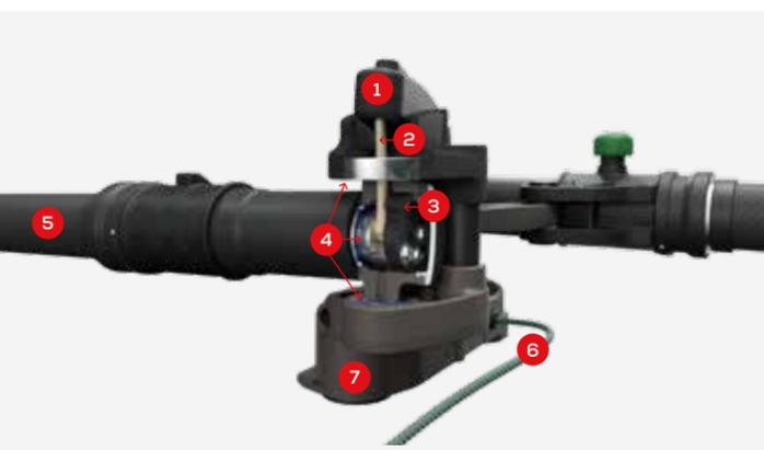
1. Stabile Wippe / 2. Hochfeste Pleuelstangen mit Kugelkopf / 3. Anschlag- Nocke für definierten Blattstand / 4. Leicht laufende Kugellager für leichtes Ruderblatt-Verdrehen / 5. Griff- und Ruderblatt-Rohr aus Kohlenfaser / 6. Entriegelungsleine zum Einklappen der Ruderriemen / 7. stabile Schwenkdolle
