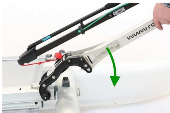
2) ... und Bolzen vollständig in den hinteren Querbalken einschieben.
