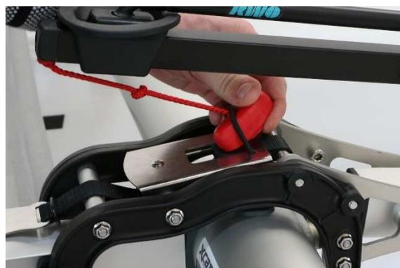
2) Knoten aus dem Schlitz lösen und das Steuerruder vorsichtig absenken.
