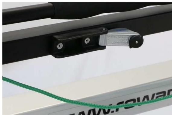
... dann Sicherheitsklemme wieder in die Halterung drücken und an der grünen Leine bis zum Anschlag ziehen und die Leine in der Sicherheitsklemme fixieren.
