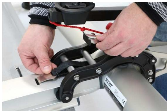
4) Spannhebel schließen.
