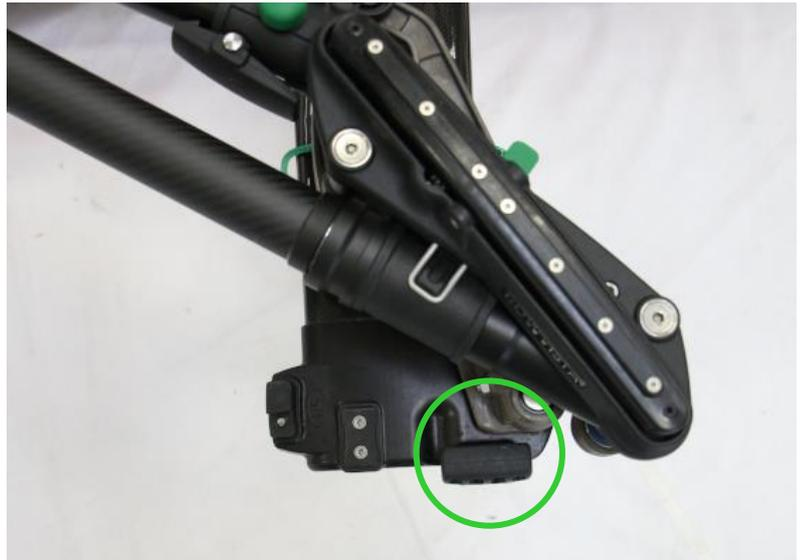
10) Der Ruderriemen kann nun durch abziehen vom Zapfen der Schwenkdolle entfernt werden.
