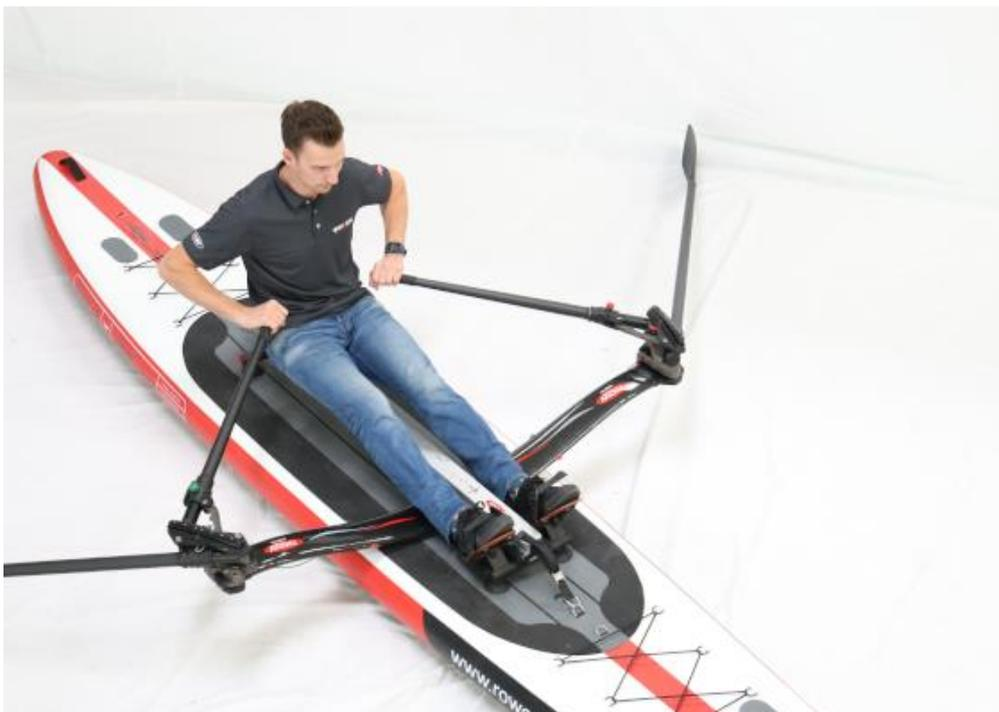
Info: Auch in der Endzugsposition ist ein Anschlag eingebaut. Wenn der Anschlag beim Rudern erreicht wird und das Blatt noch im Wasser ist, wirkt das Ruderblatt wie ein Steuerruder und man spürt einen leichten Ruck. Es ist also empfehlenswert nicht ganz bis zum Anschlag zu ziehen und das Ruderblatt beim Austritt aus dem Wasser sofort aufzudrehen. Dann bewegt sich das Blatt durch den Wasserdruck fast wie von selbst aus dem Wasser. Dabei dürfen die Griffe jedoch nicht zu stark festgehalten werden.
