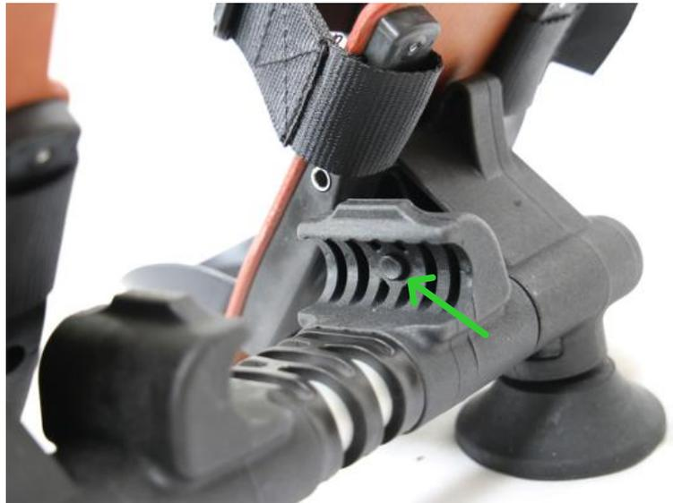
Hinweis: Beide Klemmzapfen des Stemmbretts müssen beidseitig in den seitlichen Bohrungen am Ende der Rollschiene stecken, bevor der Klemmhebel umgelegt werden kann.
